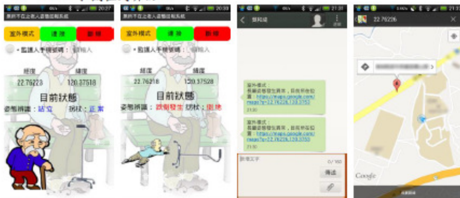
圖 4-10、正常狀態下及發生跌倒時手機接收到簡訊，並透過手機 GPS 定位
