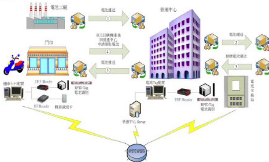
圖 1：「自動化電池交換作業系統」整體邏輯架構
